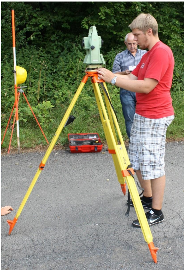
Einspielen der elektronischen Libelle durch die Fußschrauben
